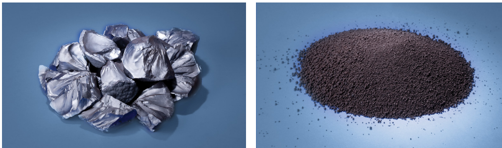
图 1. 西门子块状硅与 FBR 粒状多晶硅
